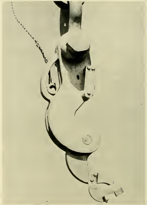
Fig. 12.32 U.S. Navy safety hook. (NAVOCEANO)
